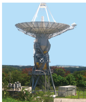
沖縄第2可搬局用パラボラアンテナ
