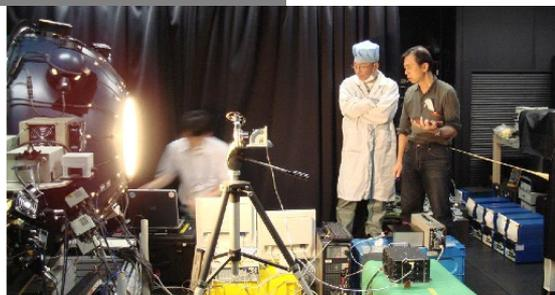
PLANET-C 機械電気噛み合わせ試験から
