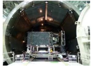
図1 熱真空試験(平成21年10月)
