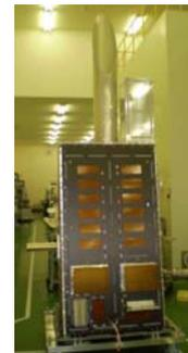
1号機ミッション部構造試験モデル
