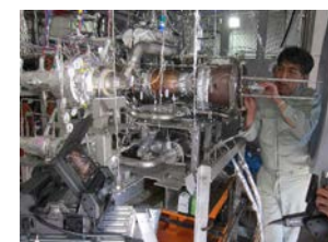
寿命管理された燃焼器の点検 (繰り返し燃焼試験後)
