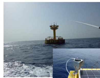
GPS津波計からのデータ伝送実験(@高知県室戸沖)
