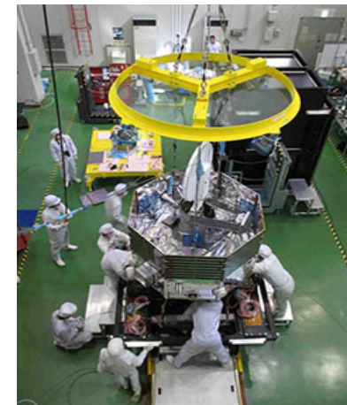
熱真空試験の様子
