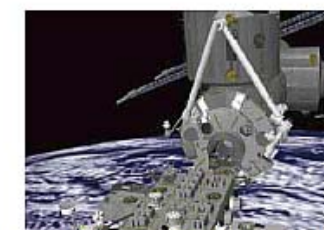
5 実験終了。「きぼう」のロボットアームを地上から操作し、サンプルをエアロックから「きぼう」船内に回収。
