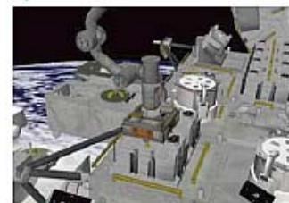
3 「きぼう」のロボットアームを地上から操作し、「きぼう」の船外部分にある手すりに取り付ける。
