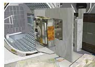
2 船外簡易取付機構 (ExHAM) に搭載サンプルを取り付け、「きぼう」のエアロックから船外に搬出する。
