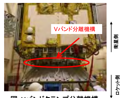
図: Vバンドクランプ分離機構
