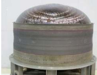
図2 3段モーターケースの試作
