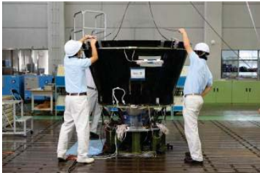
図1 2段ノズル伸展試験
