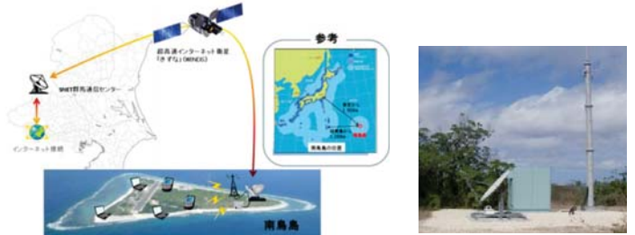
離島向け衛星通信システムの検証実験概要(左)と南鳥島の地球局(右)
