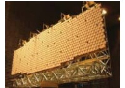
SARアンテナの試験状況
