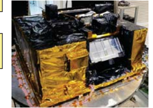
SGLI 可視・近赤外放射計部(VNR) エンジニアリングモデル
