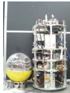
左：3軸ドラッグフリー制御システムにおける微小重力実験部(左)と本システムの微小重力実験部(右)の比較 右：他の飛行手段との飛行頻度及び実現可能な重力レベルの比較・分析結果
