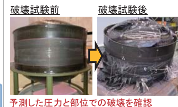
予測した圧力と部位での破壊を確認
