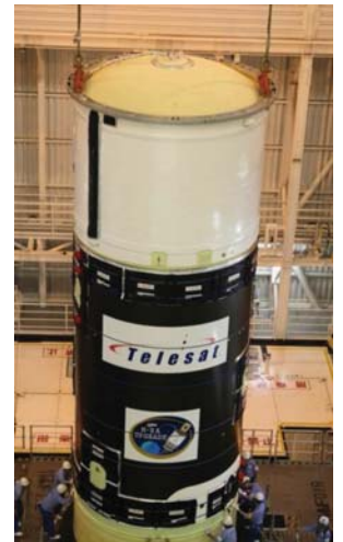
組み立て中のH-IIA29号機。 長時間飛行に備え、太陽光入射による機体温度上昇を抑えるために2段機体白色塗装をするなど、性能向上のための工夫が施されている。
