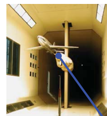
スティング支持装置
