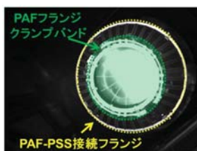
PAFフランジ クランプバンド PAF-PSS接続フランジ デブリ最接近時の画像航法アルゴリズム(カメラベースで低コスト化に貢献)
