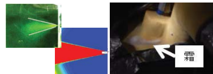
水素漏洩解析及び機体実機大漏洩試験の実施 極低温推進剤タンク繰り返し充填による断熱材試験
