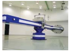
旋回腕型 加速試験設備
