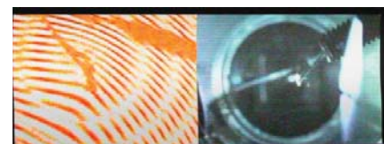
酸化アルミニウムの蒸気から宇宙ダスト(微粒子)が生成する様子。左画像の干渉縞の変化から、生成時の温度と濃度がわかる。左は二波長干渉縞画像、右は可視光画像。(S-520-30号機実験)
