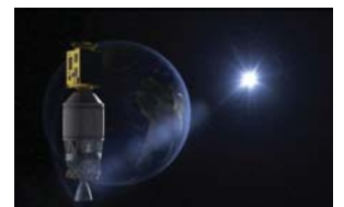
宇宙空間を飛行中のH-IIAロケット(イメージ)。 高度化開発により約5時間、地上から36,000kmの距離でも飛行できるようになった。
