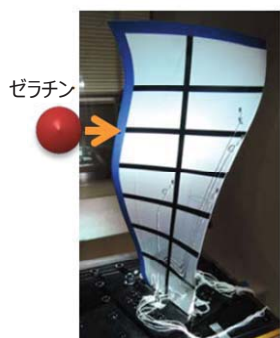
中空CFRPブレードの耐衝撃性試験
