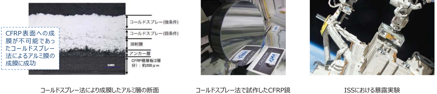
コールドスプレー法により成膜したアルミ層の断面
