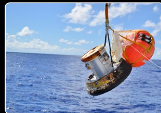
回収船に揚収された HTV搭載小型回収カプセル
