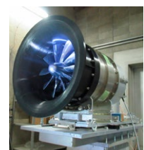
電動推進システムによる検証試験
