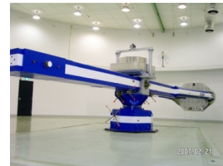
旋回腕型 加速試験設備
