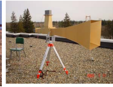
PARC: 電波の能 動型反射装置
