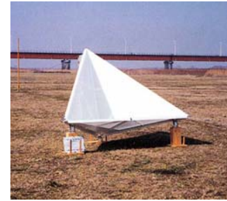
コーナーリフレクタ (CR): 電波の受動型 反射装置
