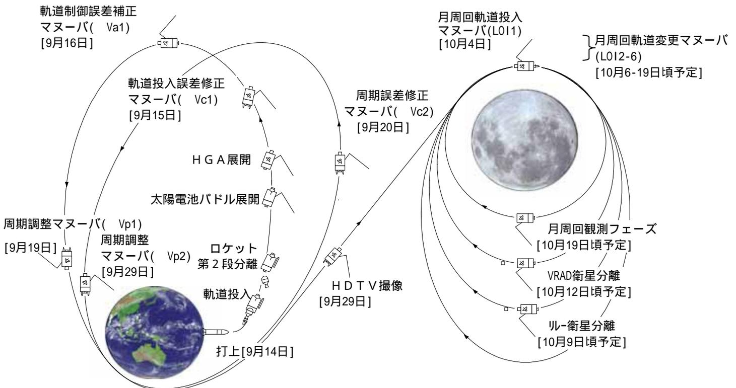
月周回軌道変更マヌーバ(L012)：投入された月周回軌道の高度を下げる軌道制御(図)
