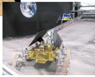
月着陸探査試験フィールドで試験する実験用ローバ
