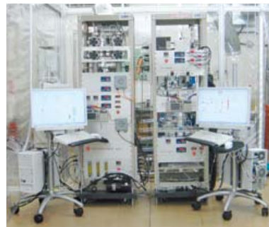
二酸化炭素から酸素を回収する空気再生装置
