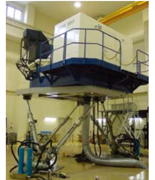
飛行シミュレータ設備
