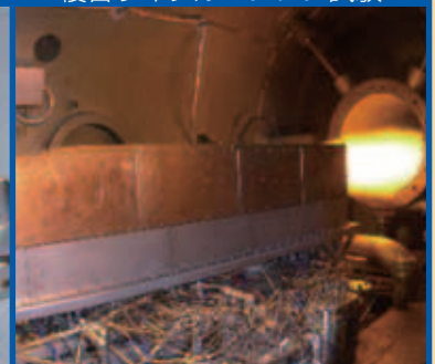
複合エンジン燃焼器試験
