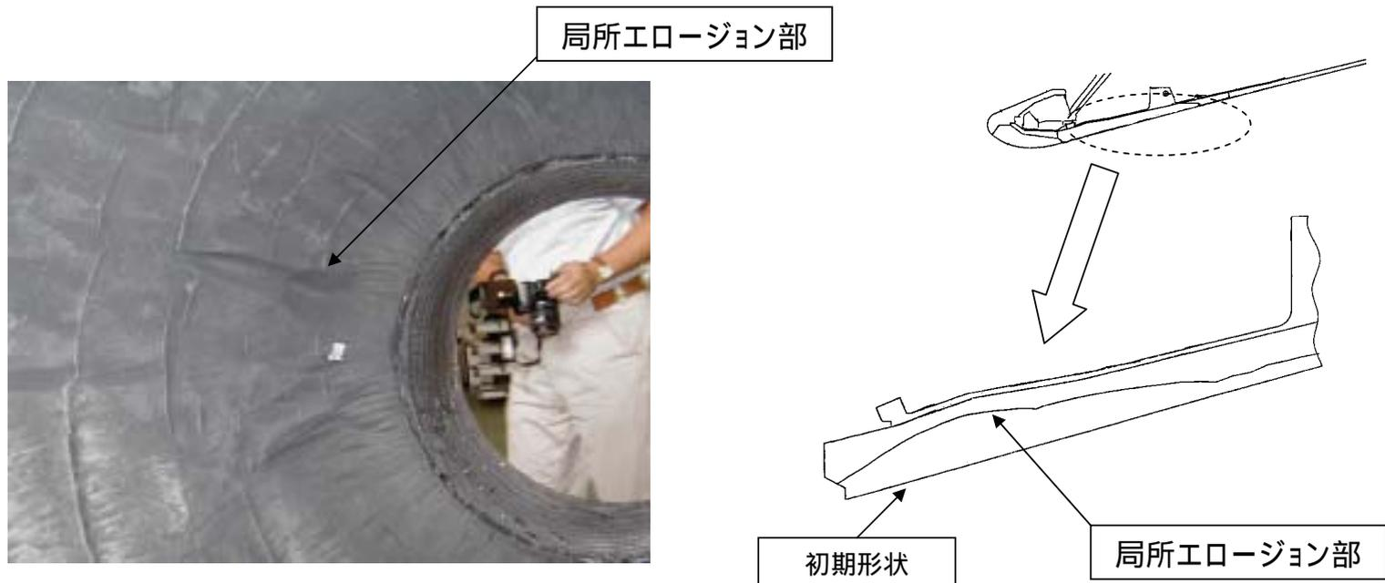
QM3 燃焼試験後ノズル開口部
