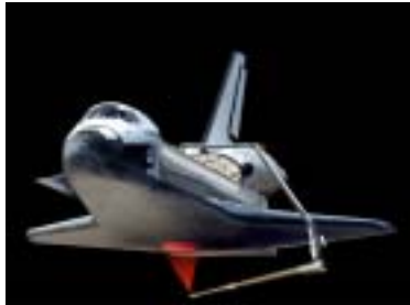
飛行2日目:OBSS を使用した耐熱タイル等の検査
