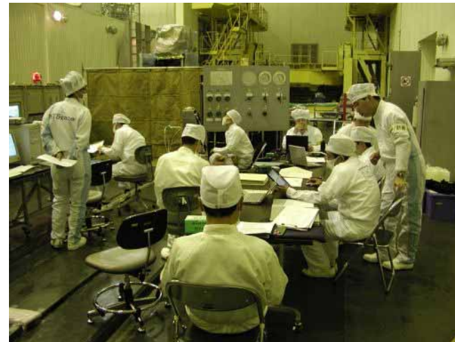
RCSリーク試験(タンク昇圧中)
