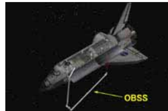
検査用延長ブームによるオービタの損傷点検
