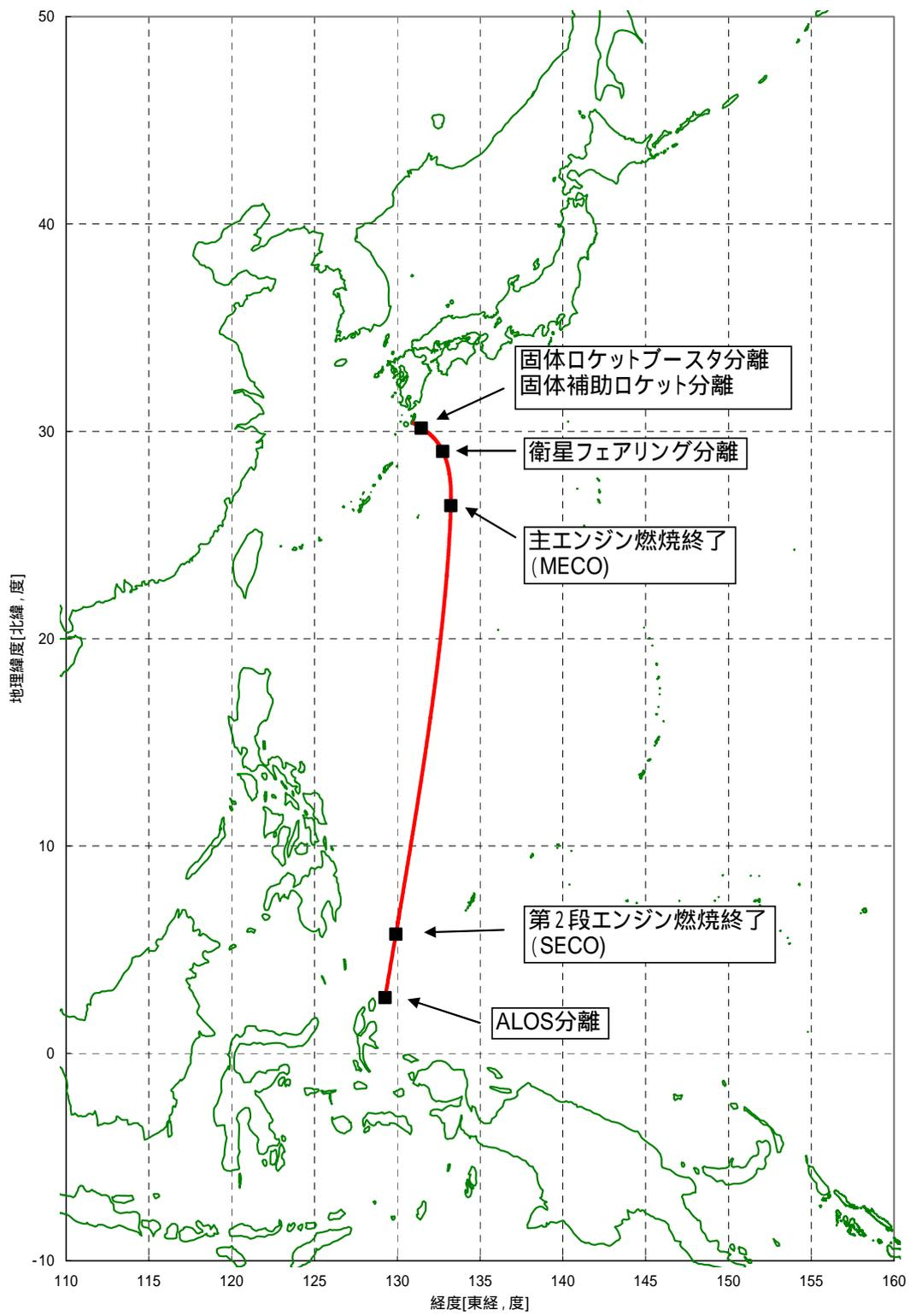
図 - 2 ロケットの飛行経路
