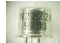
図2-2 異物混入のトランジスタと同型品
