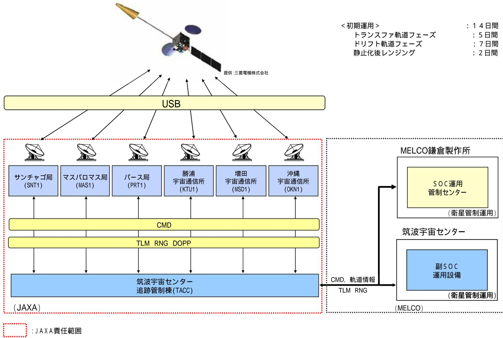
図 - 6 MTSAT - 2 追跡管制システム構成
