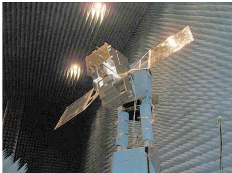
Sバンドアンテナ特性測定試験 (1/4スケールモデル) (18年4月)
