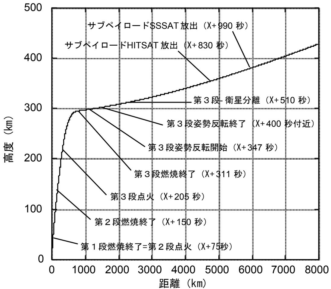
第3図 (1 / 2) M-V-7号機飛行経路
