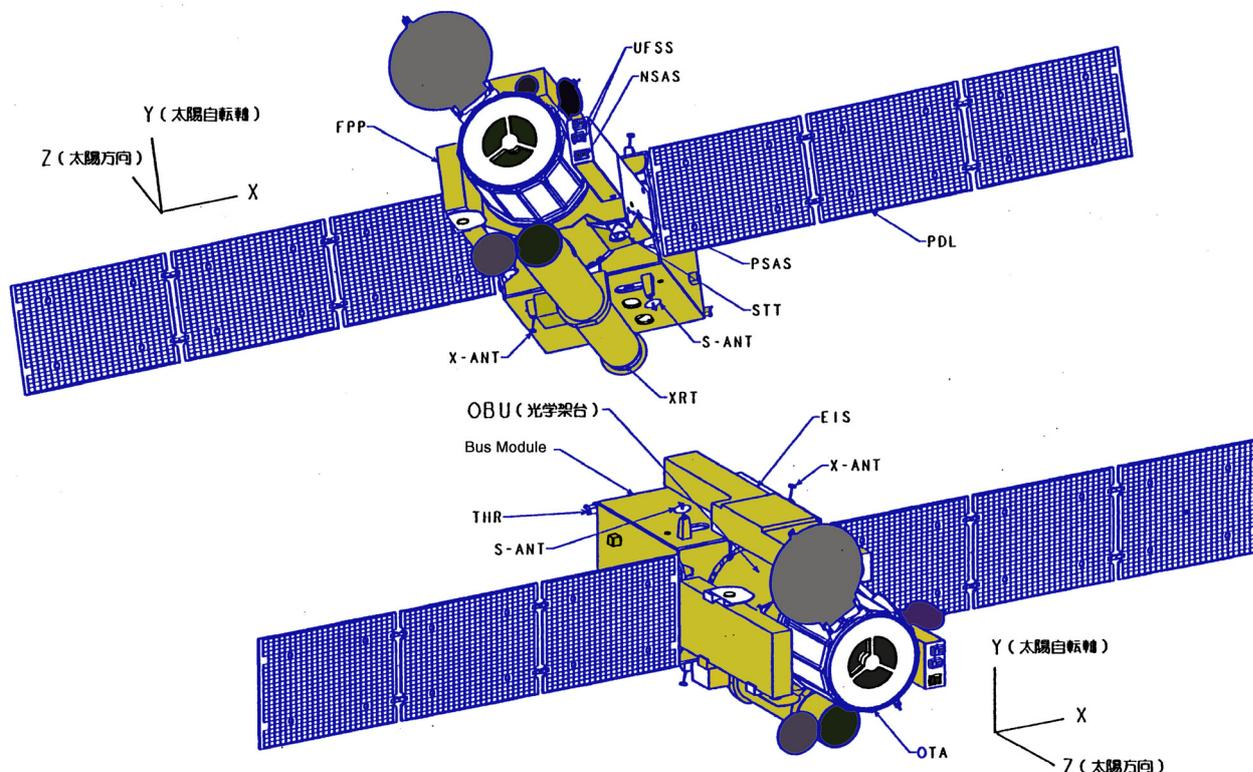
第4図 SOLAR-Bの概観図(軌道上での最終形状)
