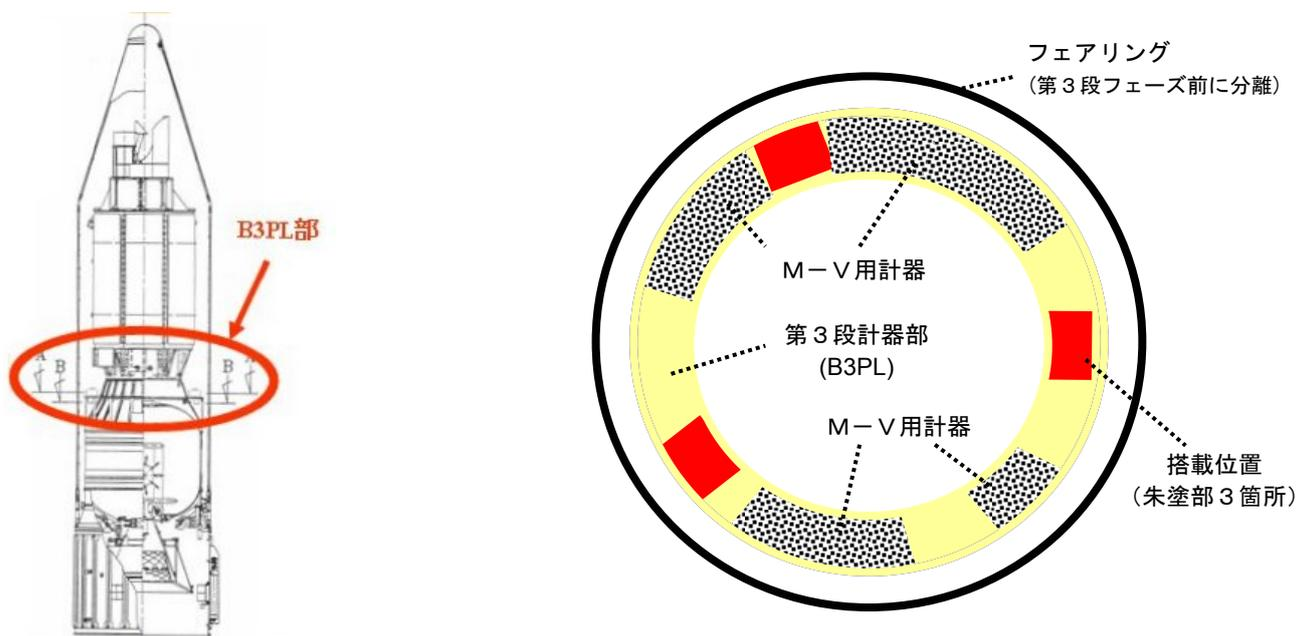
第8図 サブペイロード搭載位置 (右図は搭載部を上から見た配置概要)
