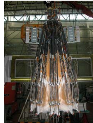
保持解放機構 展開試験 (平成18年3月)
