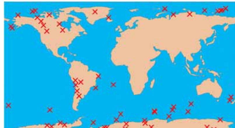
図2:磁気嵐時のビット反転発生場所(2003年10月)
