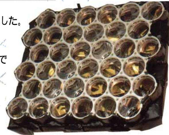
ETS- 搭載レーザー反射鏡
