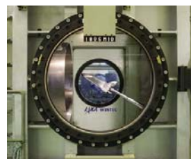
図3 1.27m極超音速風洞 (極超音速風洞として世界最大、気流の質も世界一)
