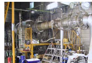
写真2 我が国唯一、実機圧力・流量で実機型(環状)燃焼試験が可能
