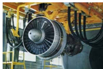
写真4 開発用エンジンテストセル 国産小型エンジン用に改修中
