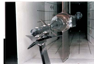
図4 1m×1m超音速風洞 (超音速領域を飛行する航空機・宇宙機の開発に必須)
