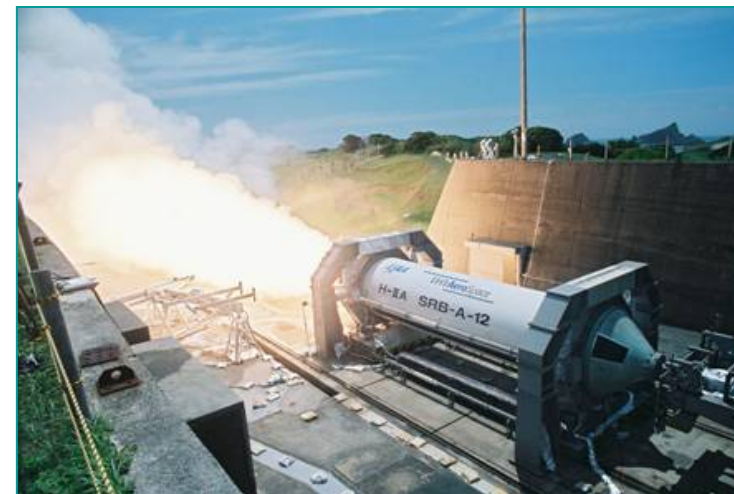
実機大モータ地上燃焼試験状況
