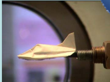
SCIENCE誌でも紹介されたマッハ7での極超音速風洞試験
