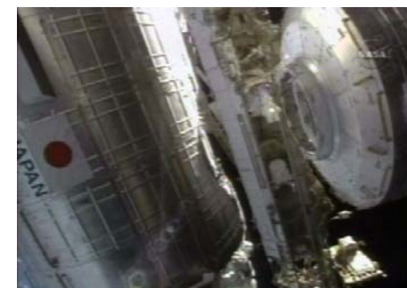
船内保管室を船内実験室へ移設
