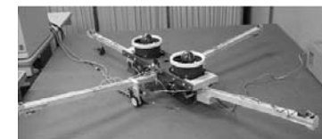
VTOL姿勢制御検討用電動模型による浮上実験
