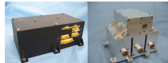
放射線環境計測装置概観 (左:電気処理部 右:センサ部)
