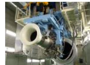
国産開発 ESPRエンジンによる実証試験
