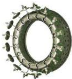
(図1) Rich-Lean燃焼方式 環状燃焼器
