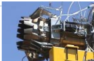
ジェット騒音試験に使用 した騒音抑制装置
