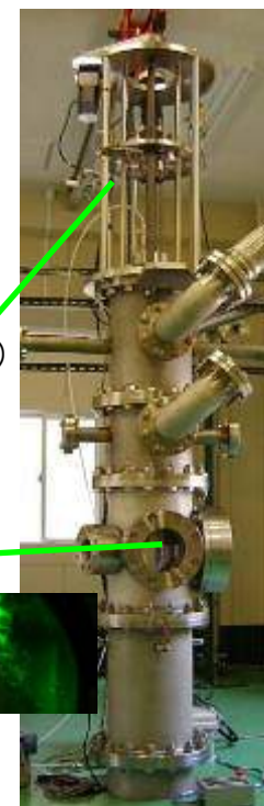
(図1)高圧噴霧試験装置
