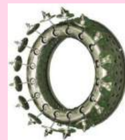
Rich-Lean燃焼方式 環状燃焼器
