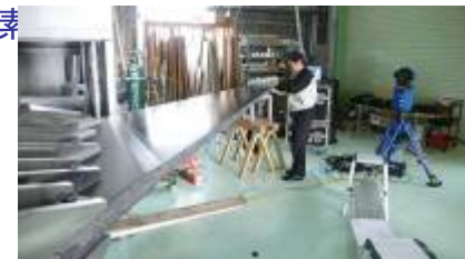
構造要素レベルでのプロトタイプに目処 空力形状との誤差: ±2.0mm以内 目標強度(6G*29)での耐荷確認
