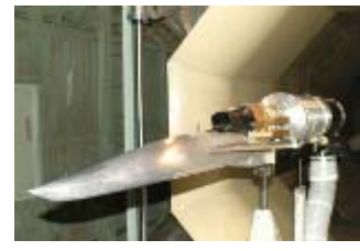
インテーク*20特性風洞試験
