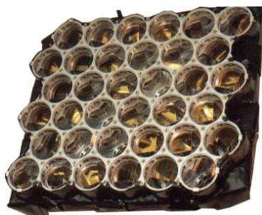
ETS-VIII搭載レーザ反射鏡
