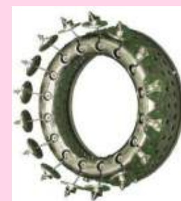
Rich-Lean燃焼方式環状燃焼器
