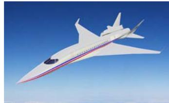
\*技術目標は、乗客1人当たりの運航コストを亜音速機の1.3倍以下に抑えて、かつコンコルドに比べて離着陸時騒音は約1/10、ソニックブーム強度は半減させて小型SST規模でドアックレベルの音にすることに相当
