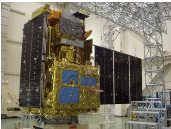
平成20年10月 筑波宇宙センター 総合環境試験棟内GOSATプロトフライトモデル最終組立作業の様子
