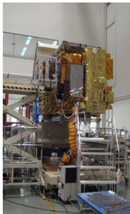
筑波宇宙センターでの最終電気性能試験風景(H20.10.10)
