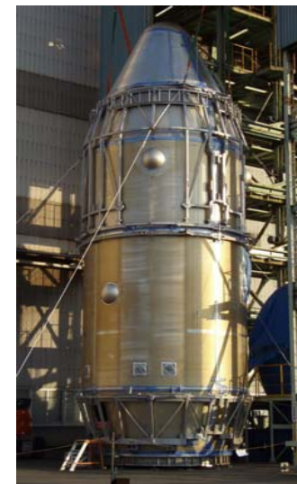
5S-Hフェアリング 強度試験供試体
