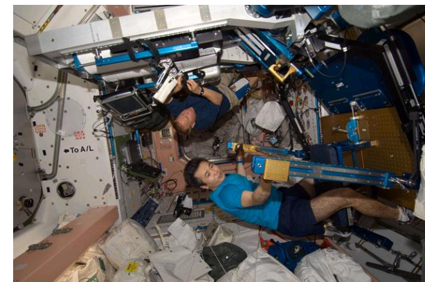
改良型エクササイズ装置のメンテナンス
