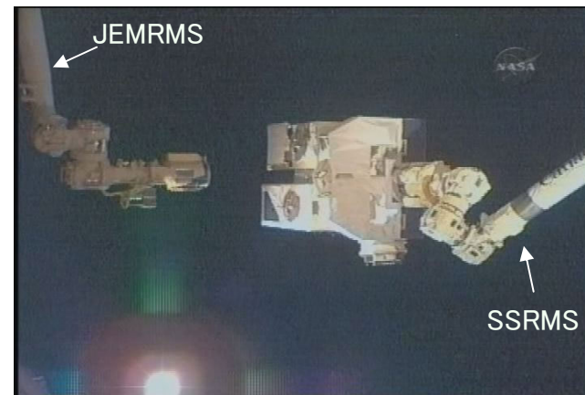
SSRMSからJEMRMSへ曝露パレットのハンドオーバの状況
