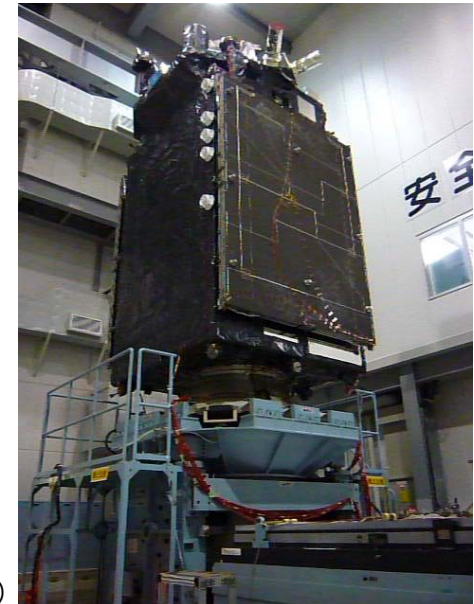
左:初期電気性能試験 中央:熱真空試験準備作業 右:正弦波振動試験 (於:三菱電機鎌倉製作所)
