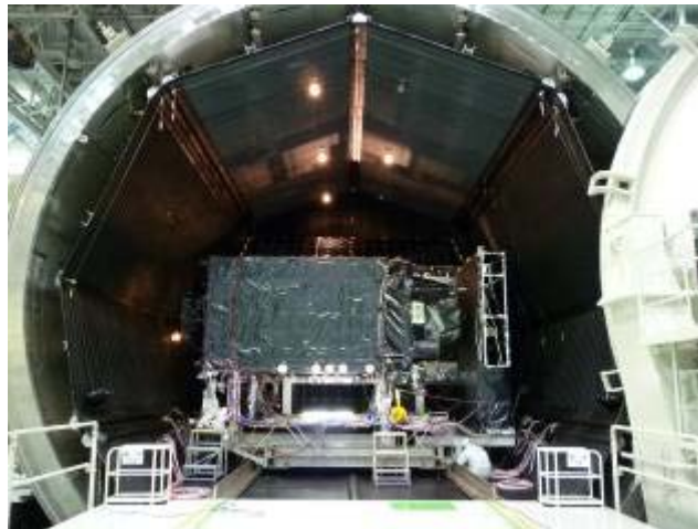
左:初期電気性能試験 中央:熱真空試験準備作業 右:正弦波振動試験 (於:三菱電機鎌倉製作所)
