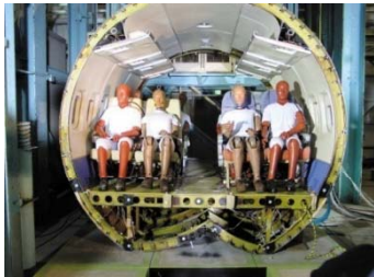
胴体の垂直落下試験の試験後の様子
