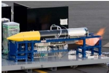
極超音速エンジン燃焼実験 (地上静止、液体水素燃料)
