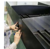
フェーズドアレイによる複合材内部損傷の探査
