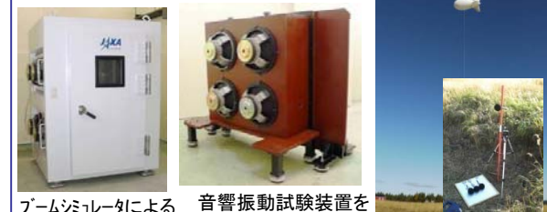
ブームシミュレータによる 被験者試験 音響振動試験装置を用いた基礎試験 ソニックブーム計測技術
