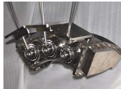
希薄予混合ステージング型 マルチセクタ燃焼器
