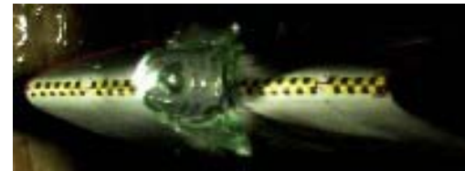
主翼前縁供試体への鳥衝突試験の様子
