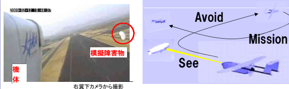
搭載センサによる障害物検知・衝突回避
