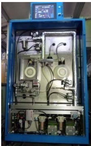
航空機エンジン用排煙濃度計 (JAXA開発)
