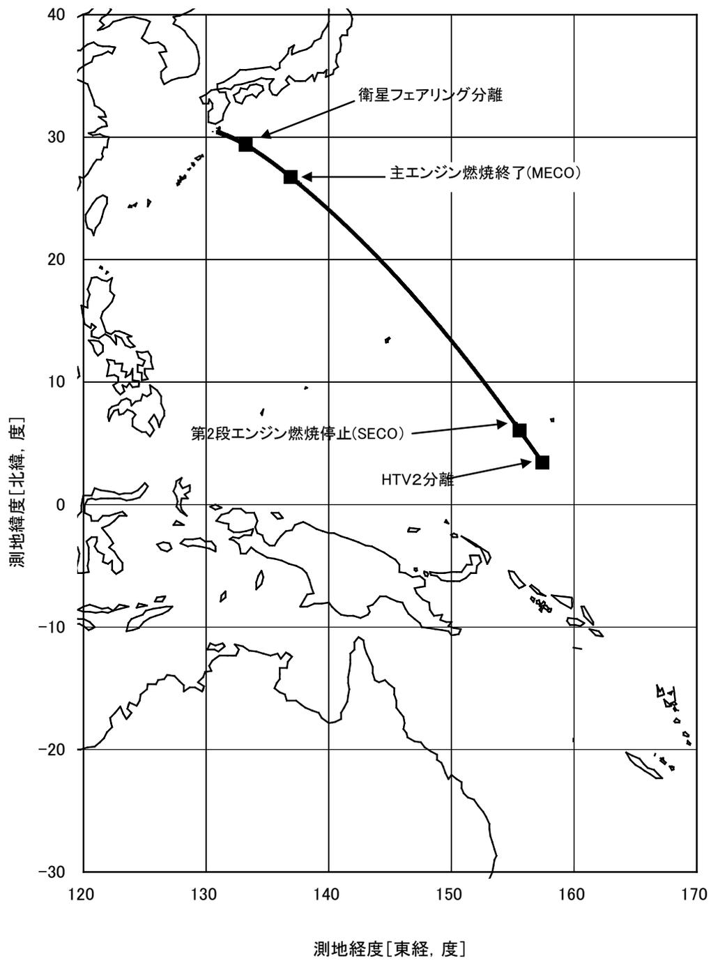
図 2 - 1 ロケットの飛行経路
