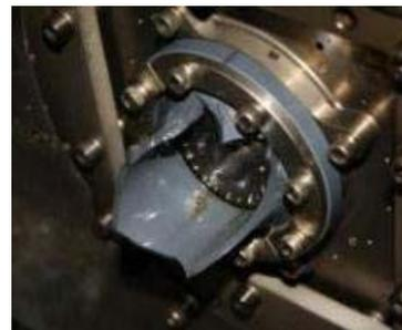
再着火後に破損が進行した燃焼器
