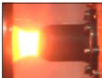
設計条件を逸脱した燃焼状態でのスラスト破損事例 (VOI-1再現地上燃焼試験)
