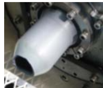
設計条件を逸脱した燃焼状態でのスラスト破損事例 (VOI-1再現地上燃焼試験)
