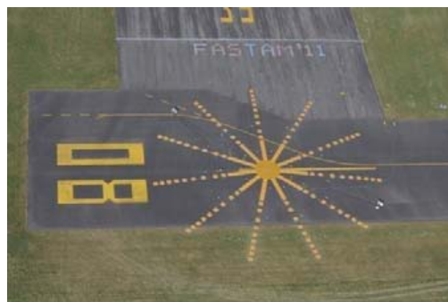
上空から撮影したフェーズドアレイ (アレイ直径50m)
