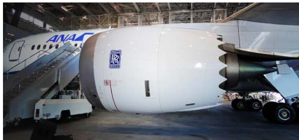
ボーイング787のシェブロンノズル (ANA HPより抜粋)
